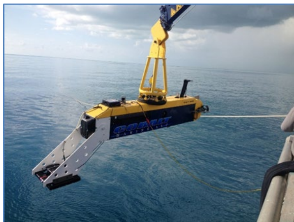
HAUV Dolores with Gen-1 EM array
